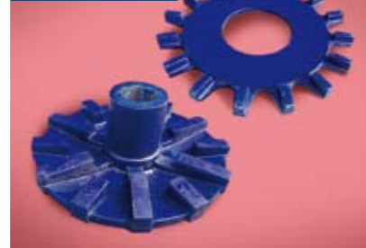
CELDA DE FLOTACIÓN (POLIURETANO)
