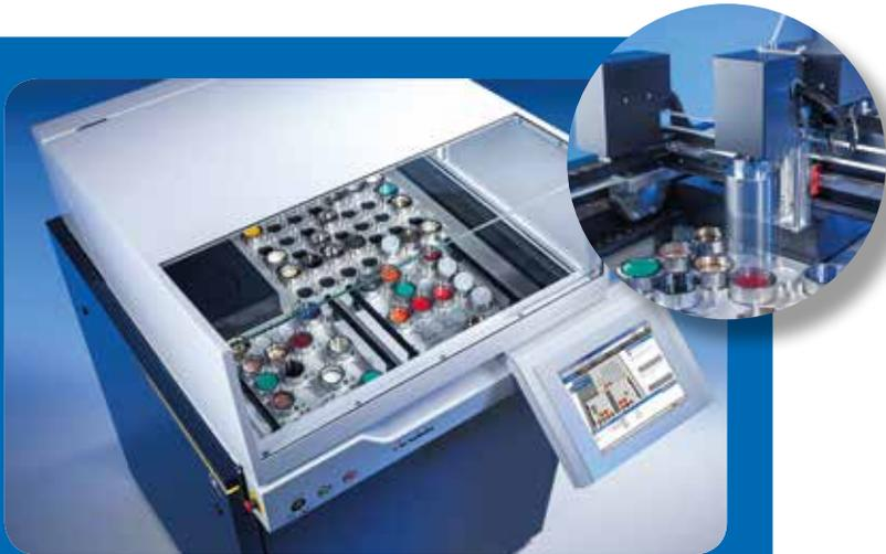
Cargador EasyLoad de 75 posiciones (71 posiciones con detección automática de muestras líquidas)
