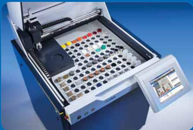
108 posiciones para muestras sólidas con pinza de vacío para muestras planas (pellets prensados y perlas fundidas)
