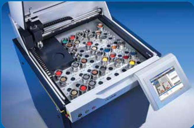
Cargador de copas portamuestras con 60 posiciones para muestras pesadas y mapeo XRF<sup>2</sup> con cámara HD
